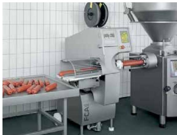
FIGURA 38 – Clipadora acoplada à embutideira.
