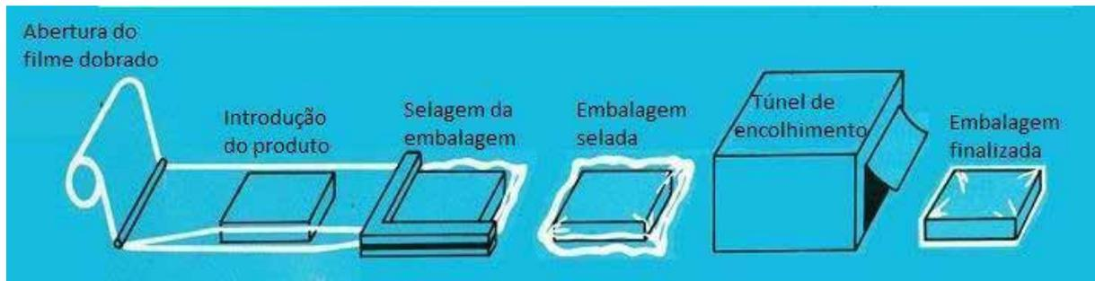
FIGURA 23 – Diagrama de funcionamento da seladora em L.
