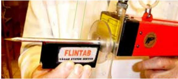
**FIGURA 1** – Pistola de tipificação de carcaças suínas (Hennessy Grading Probe)
