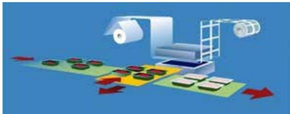
FIGURA 34 – Diagrama de funcionamento da seladora de bandejas automática.
