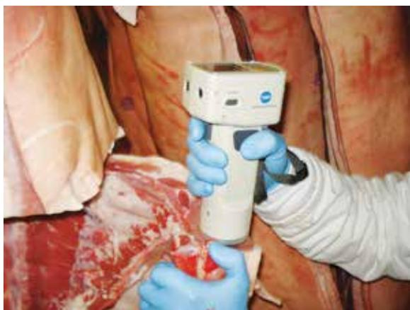
**FIGURA 6** – Avaliação de cor na área de olho de lombo, com a utilização do colorímetro Minolta.
